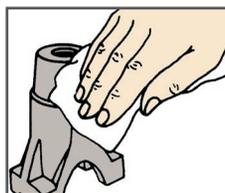
Aplique uma porção de limpador num pano e remova o penetrante ou lave com água.
