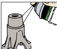
Faça uma pré-limpeza na área de inspeção. Aplique o Limpador e esfregue com um pano.
